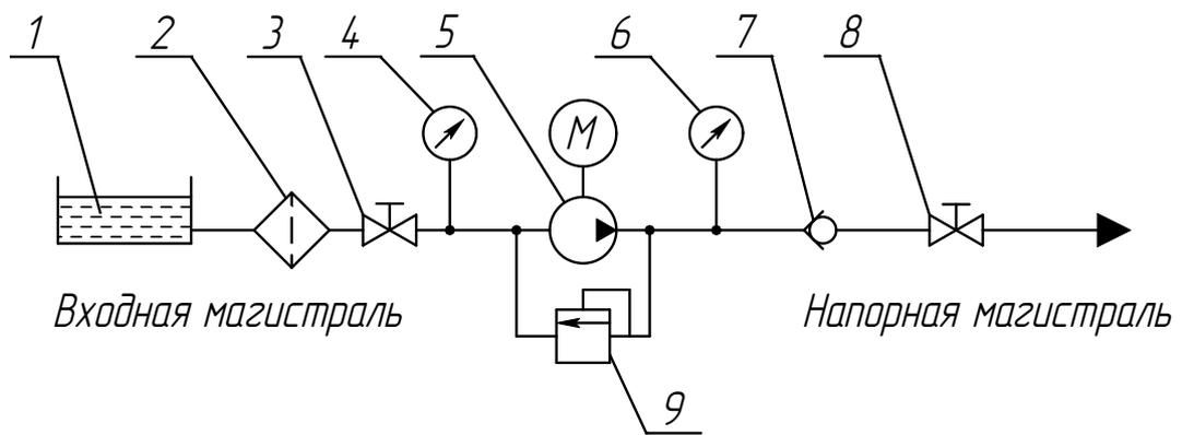
Рисунок 2 – Схема включения агрегата в сеть
