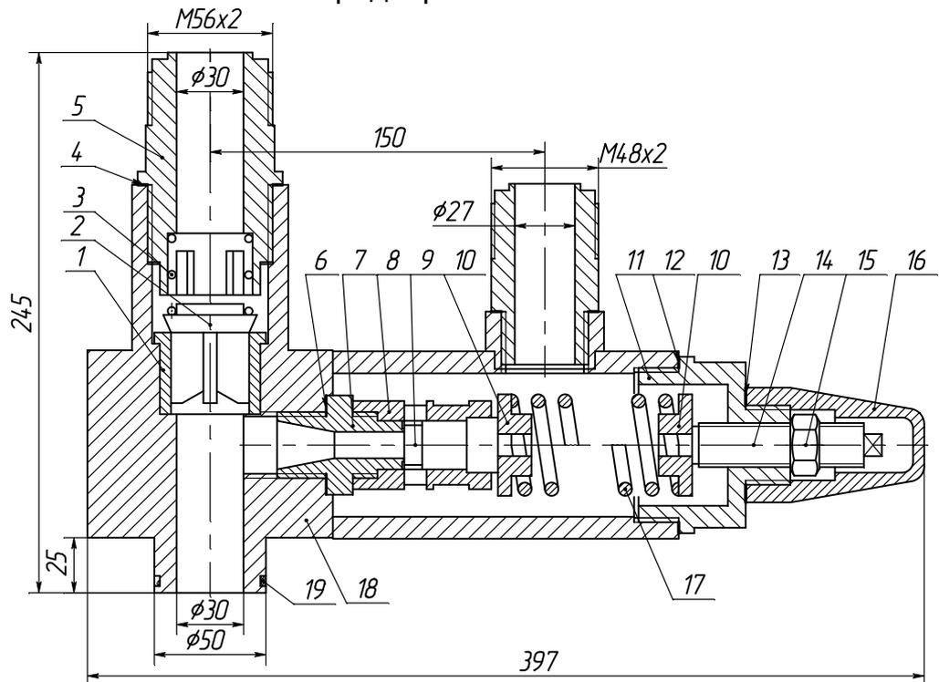
Рисунок 3 - Предохранительный клапан
