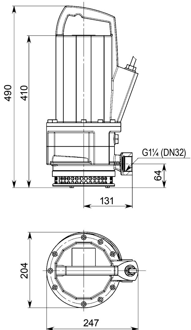
Насос представляет собой моноблочный электронасосный агрегат, состоящий из электродвигателя и насосной части, разделённых системой торцовых уплотнений.
