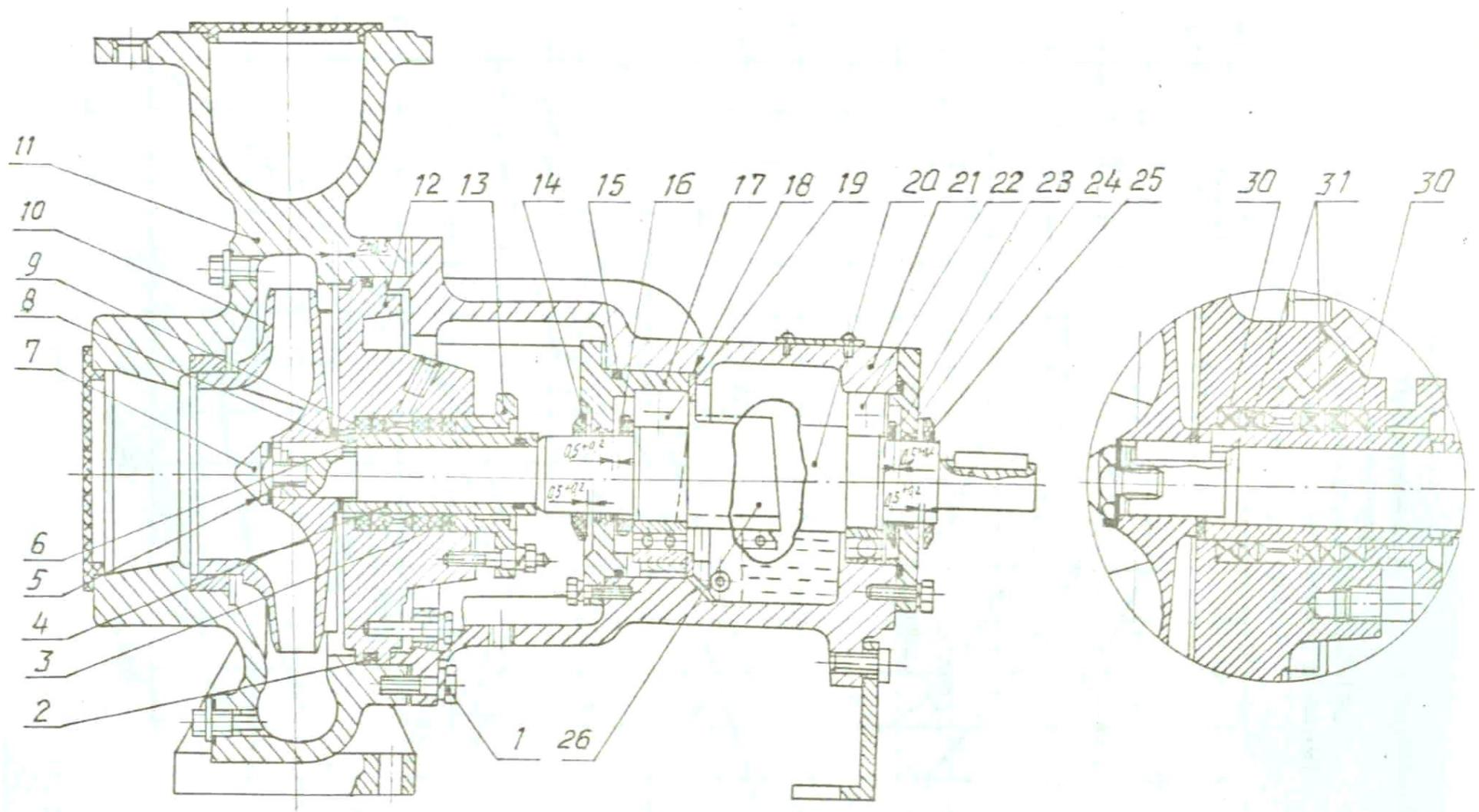
Рисунок 2 – Разрез насоса
