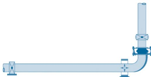
5. Компенсатор следует устанавливать непосредственно за неподвижной опорой. За компенсатором следует предусмотреть подвижные опоры
