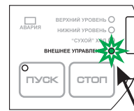
Сигнальный светодиод входа "Внешнее управление"
